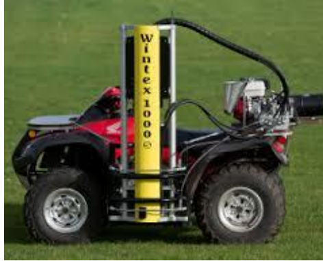
Şekil 6. Toprak Örnekleme Ekipmanı (IAGRO, 2017).
