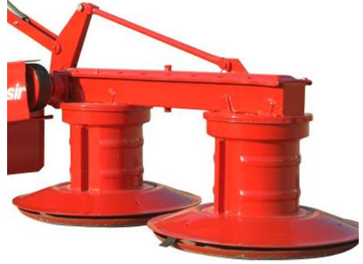
Şekil 7. Yonca hasadında kullanılan makaslama ve tamburlu biçim makineleri
