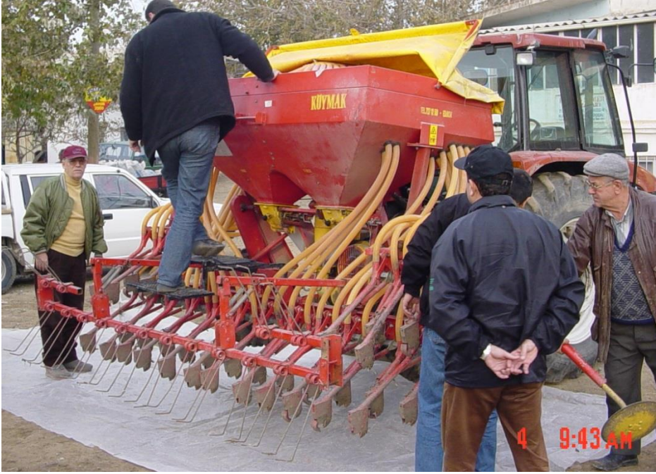
Şekil 6. Yonca ekiminde kullanılan pnömatik (havalı) mibzer (orig.)
